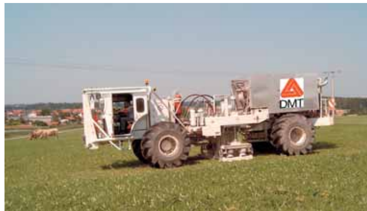
Seismische Untersuchung mit mobiler Technik
